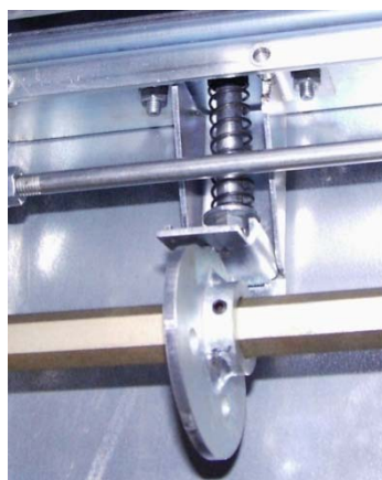
Rys. 13. Mechanizm wsunięcia członu wysuwnego do pozycji „praca” przy otwartym uziemniku i blokady załączenia uziemnika, gdy człon wysuwny jest w położeniu „praca”.
